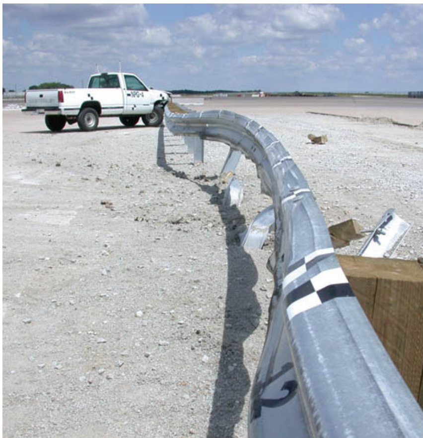
Figura 2: Guardrail deformado após desvio de veículo
